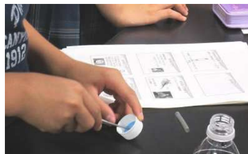
ペットボトルの肩から上の部分を使って17世紀の顕微鏡をつくります。穴の開け方がポイントです。
