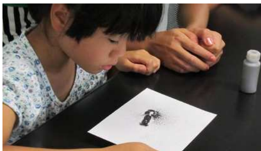
砂鉄を使って磁力線を観察します。本物を見ると感動が違います。
