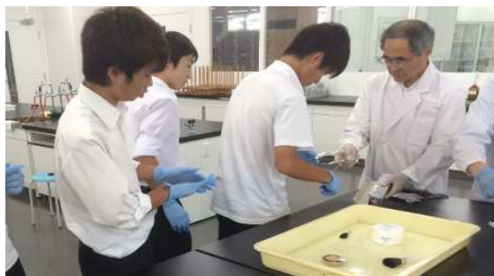
身近な物で指紋の検出実習です。ファンデーションの粉末を使います。
