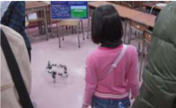
東海大学による省自由度型脚車輪ロボットの実演です。歩行機能を保ちながら省自由度化を行い軽量化や省エネルギー化を図ります。人や生き物の動きにとらわれない動き方をします。
